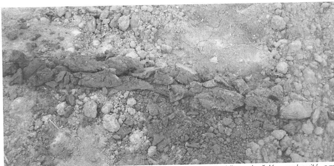
Obr. 3: Zkrácené vrtné jádro sondy HR-6 (květen 2011). Vlevo hnědá prachovitá ornice, směrem doprava přechází do podložního hnědého, rezavě a šedě šmouhovaného jílovitého prachu a dále do hnědošedého písčitého prachu.
