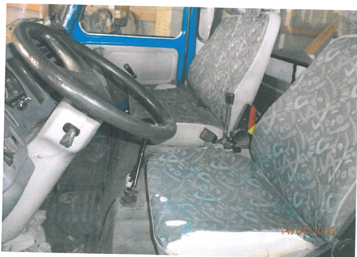
Foto č. 6 Silně opotřeбенý vnitřek kabiny vozidla
