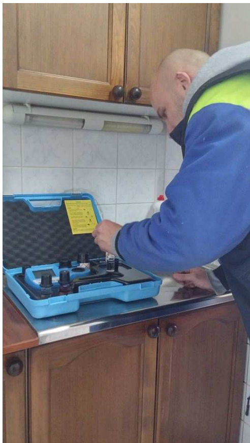
Obr. 3: Měření úrovně chloru
