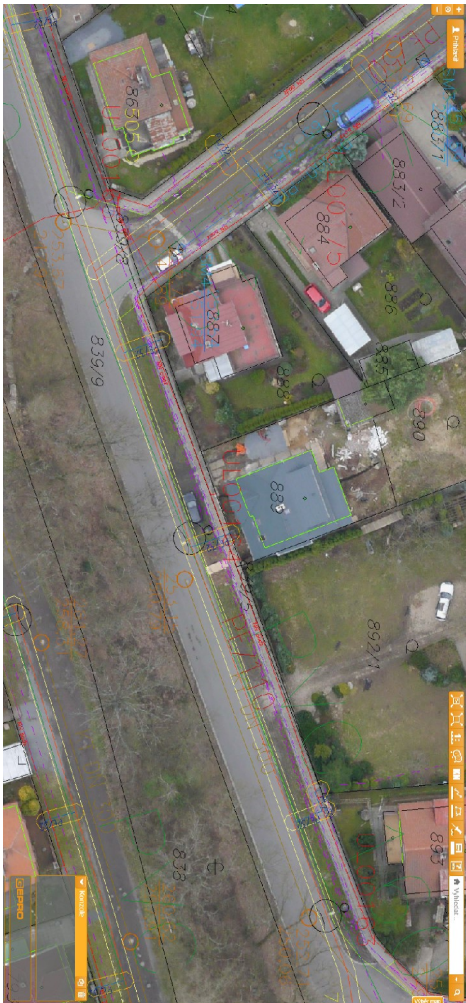
2/2 Převzatý zakres ing. sítí z technické mapy města Úvaly – detailněji viz https://uvaly.obce.gepro.cz/#/
