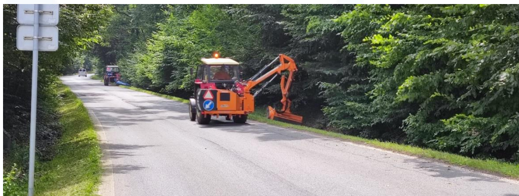
Obr. 14: Sekací rameno v akci
